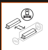
Il driver LED riparabile è disponibile come parte di ricambio, consentendo la sua sostituzione senza smaltire l'intero apparecchio. Ciò riduce gli sprechi e preserva le risorse. Inoltre, la lunga durata del modulo LED (fino a 100.000 ore – L80) riduce al minimo le sostituzioni per una soluzione di illuminazione sostenibile.
