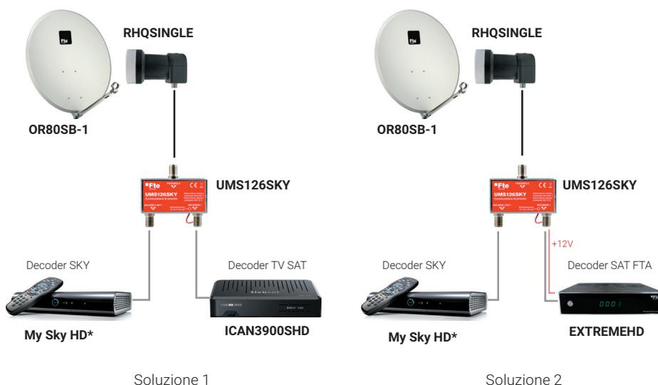
Soluzione 1: Collegare il decoder Tivusat (o altro decoder SAT) all'ingresso del decoder 1 ed il decoder Sky all'ingresso del decoder 2. Il filo rosso per comando +12V non deve essere utilizzato.
